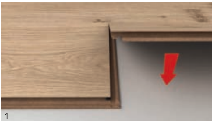
1 Der Boden wird kopfseitig dicht an der nebenliegenden Diele abgesenkt.
