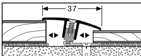
**Schraub Übergangsprofil 7-17 / 27 mm**
