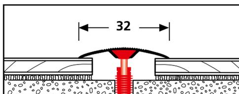
**Fix Übergangsprofil 0-20 mm**
