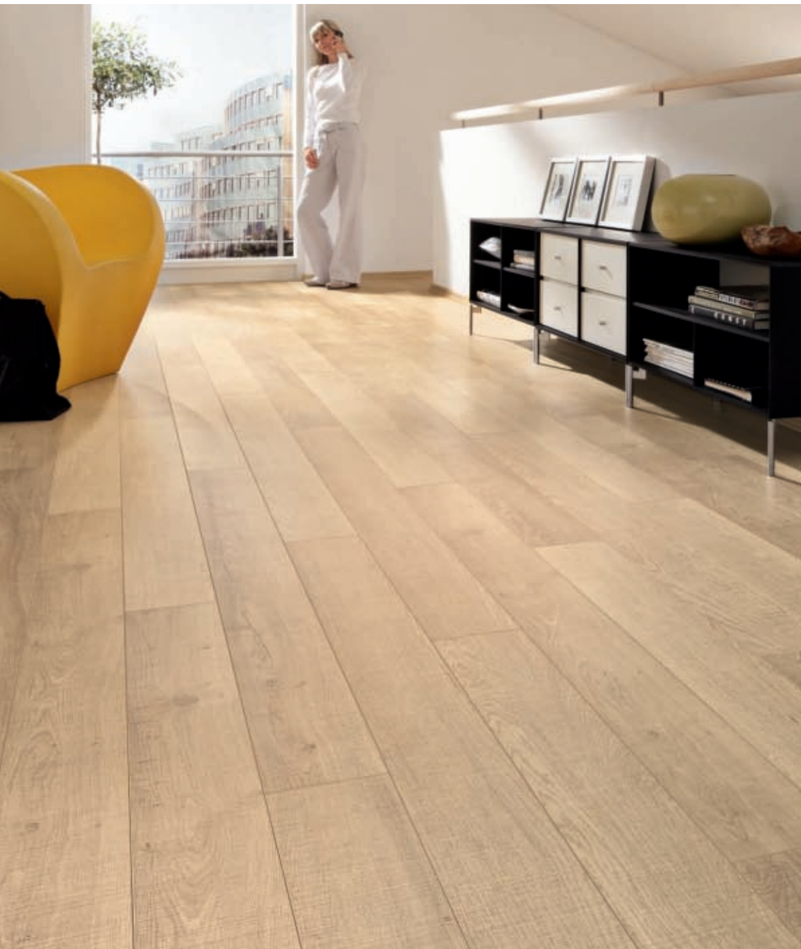
Laminatboden: LS 300 | Eiche natur 6151 | Holznachbildung Fußleiste: Profil 1 MK | Eiche natur 6151 | Holznachbildung Aluminiumprofil: Universal-Abschlussprofil Typ 287 B | Silber eloxiert
