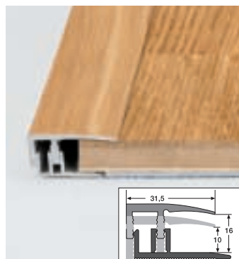
Typ 587 E Klipp-Abschlussprofil 10 bis 16 mm
