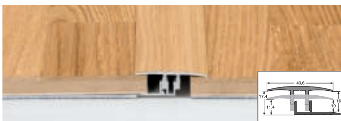
Typ 588 E Klipp-Übergangsprofil | 10 bis 16 mm
