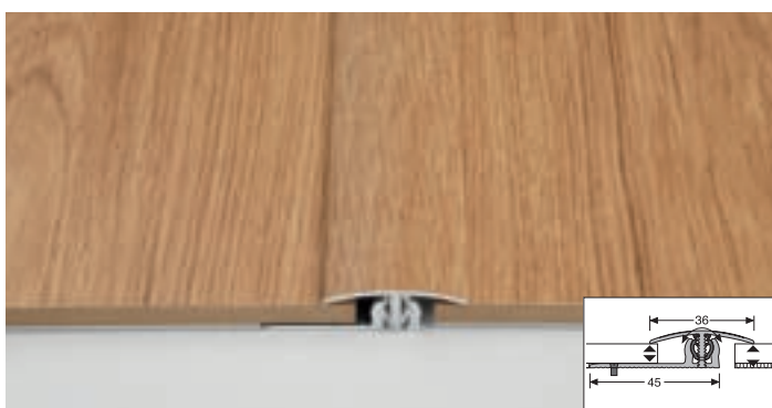
Universal-Klipp-Übergangsprofil »Flexo« | 7 bis 18 mm Neigungsverstellung 4 bis 21 mm
