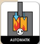
**Automatik:** Die eingestellte Wärmeleistung kann während der ganzen Feuerung konstant gehalten werden, indem ein Wärmesensor die Öffnung des Luftkanals und damit die Menge der zugeführten Verbrennungsluft permanent steuert. Die Regelung ist sogar je nach Brennstoff einstellbar. Ein Wechsel zwischen Holz und Kohle ist auch während des Betriebs möglich.
