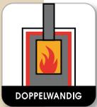
**Doppelwandige Geräte:** Durch den Konvektionsraum wird die Wärme zusätzlich zur Strahlungswärme des Kaminofens als Konvektionswärme abgegeben. Doppelwandige Kaminöfen sind hochwertiger, haben eine längere Lebensdauer und bieten größere Sicherheit.
