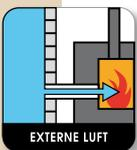
**Externe Luft:** Außenluftanschluss für sehr dichte Räume, damit die benötigte Verbrennungsluft zum überwiegenden Teil direkt aus dem Freien oder Nebenräumen zugeführt werden kann.
