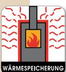
**Wärmespeicherung:** Durch die wärmespeichernden Verkleidungsmaterialien (Speckstein oder Keramik) wird nach einer entsprechenden Aufheizphase - auch nach Abbrand - eine verlängerte Wärmeabgabe bis mehrere Stunden gesichert.
