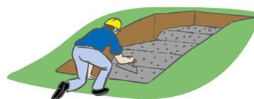
Eine Grobschalung aus Brettern und Pfosten nach den Anforderungen (Höhen) der späteren Stufenanlage erstellen. Achten Sie beim Bau der Schalung auf das Steigungsverhältnis, es muss bei der gesamten Treppe konstant sein. Diese Form mit wasserdurchlässigem Magerbeton füllen, feststampfen und 2 – 3 Tage aushärten lassen.
