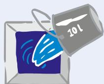
2. Füllen Sie 10 Liter Wasser in die Grube. Stellen Sie die Zeit fest, die das Wasser zum vollständigen Versickern benötigt.
