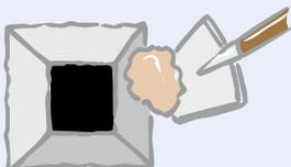
1. Heben Sie eine Grube aus: 40 cm lang, 40 cm breit, ca. 40 cm tief mit möglichst ebener Sohle.
