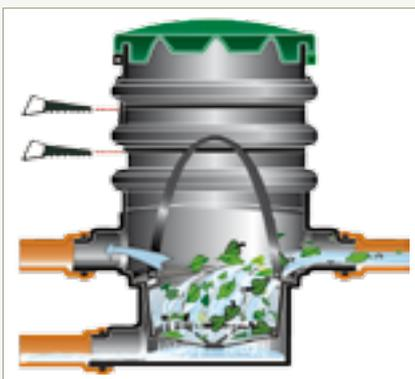
Reinigt das Regenwasser gründlich von Verschmutzungen. Mit großem herausnehmbarem Siebkorb inklusive Ausbevorrichtung. Feinmaschige Filtration ( $\varnothing$  0,35 mm). Für die Hausnutzung geeignet oder als Vorfilter für Teich- und Versickerungsanlagen. Dachfläche max. 350 m<sup>2</sup>, Höhe: 80 cm, kürzbar bis 55 cm um je 12,5 cm.
