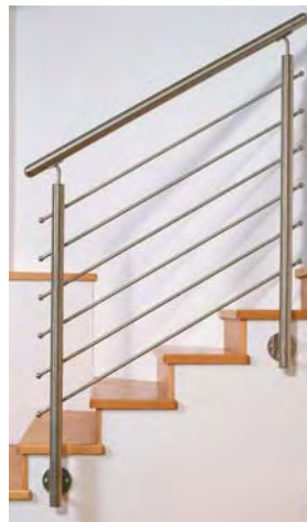
Pfosten Wandmontage (Abstand nach unten mind. 200 mm)
