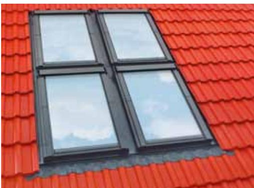
Mit den FAKRO® Kombi-Eindeckrahmen lassen sich Fenster beliebig nebeneinander, übereinander oder als Block in die Dachfläche einbauen. Bei der Standardanordnung beträgt der Abstand zwischen den nebeneinander und übereinander angeordneten Fenstern 10 cm. Das Kombi-System besteht aus sieben Modulen, mit denen nahezu jede Kombination realisiert werden kann.
