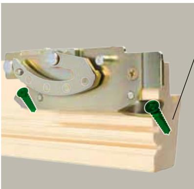
Die innovative Montagelösung der speziell profilierten Beschläge soll die Rissbildung im Holz vermeiden. Dadurch wird ein Ausreißen der Beschläge sowie ein Hineindrücken des Fensterflügels in den Innenraum verhindert.
