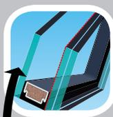
**sicher L3** - Innenscheibe aus VSG, Außenscheibe aus ESG mit selbstreinigenden Eigenschaften, isolierter TGI-Abstandhalter, Scheibenzwischenraum mit Edelgasfüllung.
